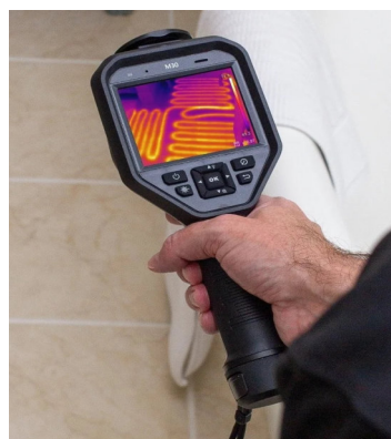
Détection de fuites dans le sol
