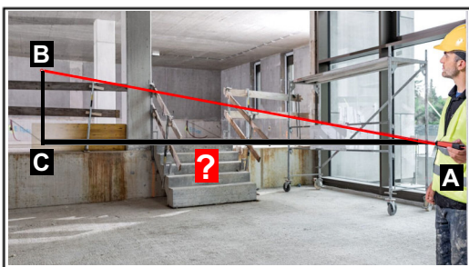
Smart Horizontal functie Meet van A naar B en geeft resultaat AC
