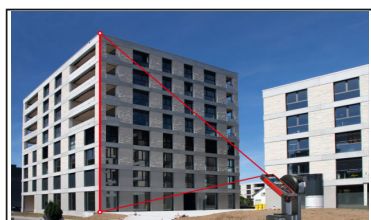
Mesure de profil de hauteur
