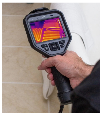
Opsporen lek in vloerwarming
